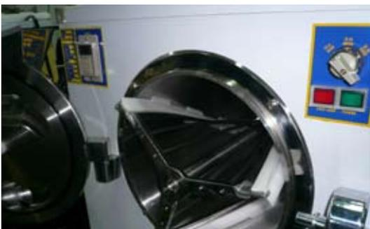
3. 裝入後，請將冰刀組順時針旋轉推入攪拌槽中，直到對準中心卡榫。
