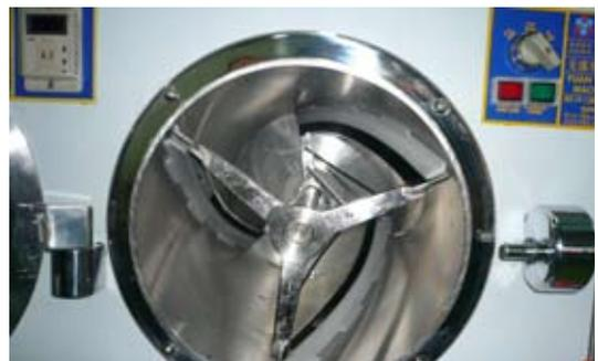
4. 請確認冰刀組是否正確裝入中心卡榫。(原料出口板可以完整密合)
