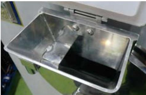
1.請將原料由此處倒入，運作製作時，可由此處看成冰狀況。
