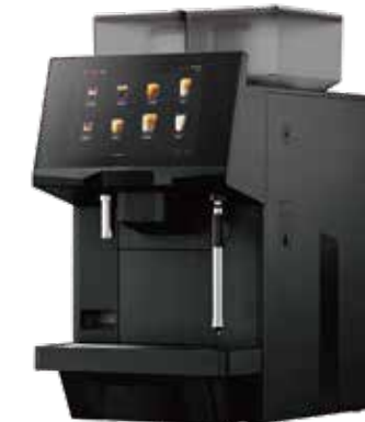
U9全自動咖啡機 尺寸：33x62x52cm 水箱：2L 豆槽：1200gx2 電壓：220V 50/60Hz 額定功率：2600W 鍋爐：700mlx2
